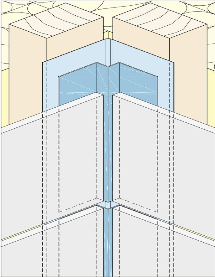
Beim Einsatz von Aluminium-Kantenprofilen können die vertikalen Profilstöße mit einer Fuge der Fassadenbekleidung übereinstimmen. Der grundsätzliche Einsatz von Fugenbändern kann das Eindringen von Wasser verhindern.
