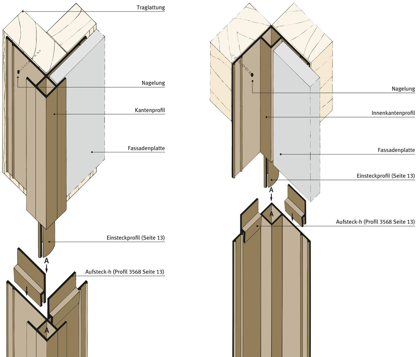
Das **Aufsteck-h Profil 3568** dichtet die Profilstöße gegen eindringendes Wasser ab.
