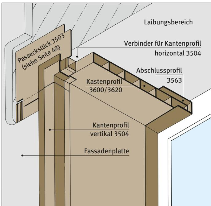
Mit den Kastenprofilen ist eine einfache und schnelle Laibungsbildung möglich. Bei geringerer Laibungstiefe können die Profile mittels einer Säge auf die gewünschte Laibungstiefe zugeschnitten werden. Das Abschlussprofil 3563 kann dabei Unebenheiten ausgleichen und überdecken.
