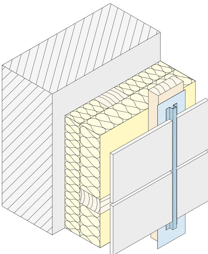
Die Fugenprofile aus Aluminium bzw. PVC finden Ihre Anwendung bei vertikaler Fuge. Je nach Anwendung ist darauf zu achten, dass eine Ausdehnung der Fassadenbekleidung möglich ist. Die Fugen- bzw. Hutprofile aus Aluminium können rückseitig oder vorderseitig der Fassadenbekleidung montiert werden.
