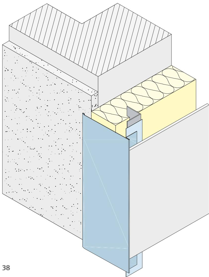
Die Anschlussprofile schließen die Fassadenbekleidung an anderen Flächen der Fassade wie z. B. Putz an und ermöglichen einen einfachen und sauberen Übergang. Sie bedecken die Schnittkanten der Fassadentafeln, bilden einen sauberen Anschluss und decken seitlich die Unterkonstruktion ab.
