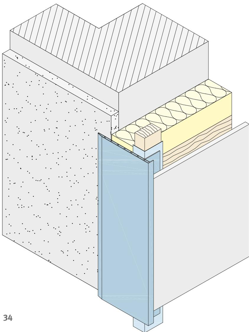
Die Anschlussprofile schließen die Fassadenbekleidung an anderen Flächen der Fassade wie z. B. Putz an und ermöglichen einen einfachen und sauberen Übergang. Sie schützen und überdecken vollständig die Schnittkanten der Fassadentafeln und decken seitlich die Unterkonstruktion ab.
