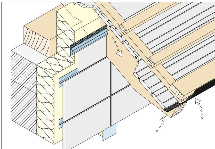
Die Lüftungsprofile 9056 und 9059 werden im oberen Fassadenbereich sowie unter den Fensterbänken eingesetzt. Die Profile können für Plattendicken von 4 – 6 mm und 8 – 15 mm verwendet werden.
