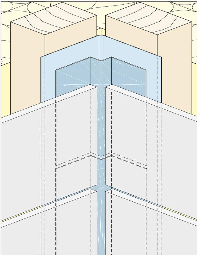
Die vertikalen Profilstöße der Aluminium-Kantenprofile können auch versetzt zur Fuge der Fassadenbekleidung angeordnet werden. Der grundsätzliche Einsatz von Fugenbändern kann das Eindringen von Wasser verhindern.
