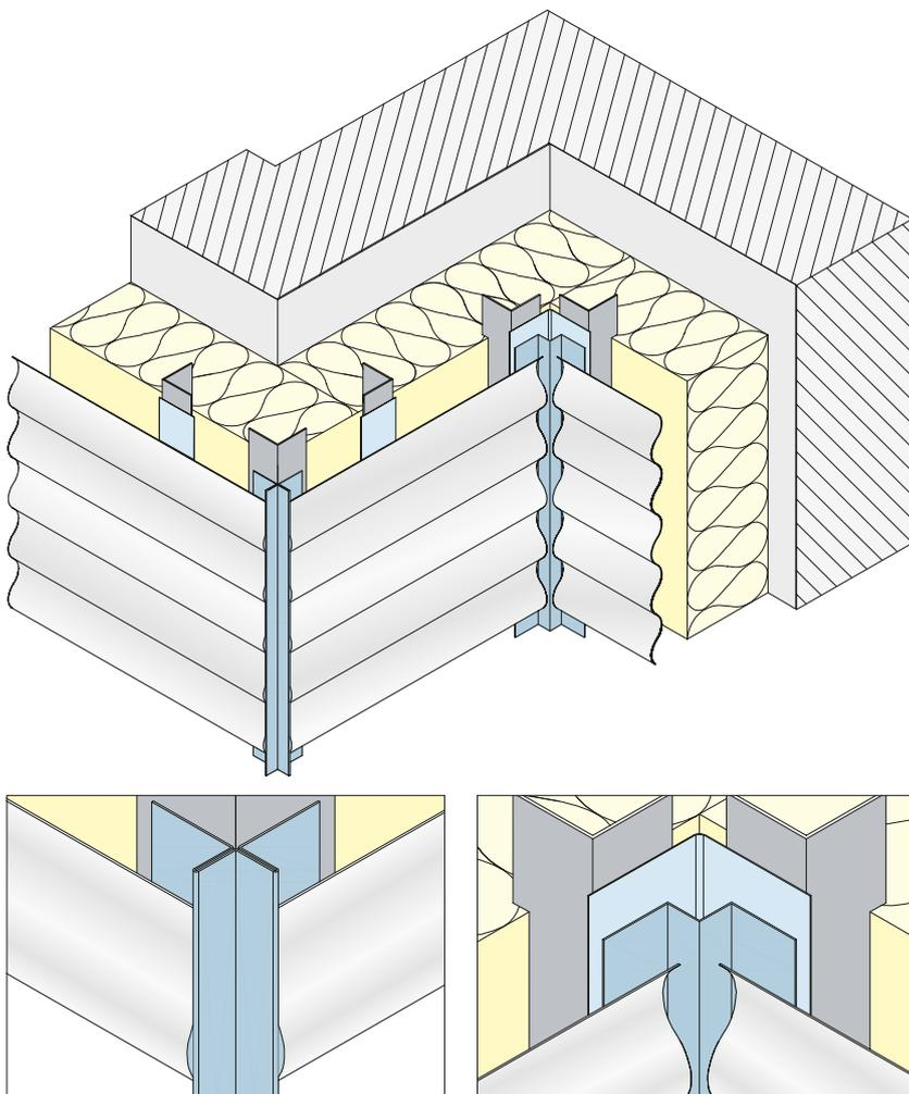
Kantenprofile für Innenecken bilden einen sauberen Abschluss der Fassadenbekleidung.
