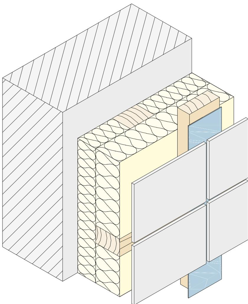
Die Fugenbänder kommen bei vertikaler Fuge zum Einsatz. Sie entkoppeln die Fassadenbekleidung und reduzieren die Geräuschentwicklung. Sie reduzieren den Wassereintritt und schützen entsprechend die Unterkonstruktion und Dämmung vor eindringendem Wasser. Bei einer Holzunterkonstruktion muß das Fugenband mindestens 5 mm je Seite überstehen.
