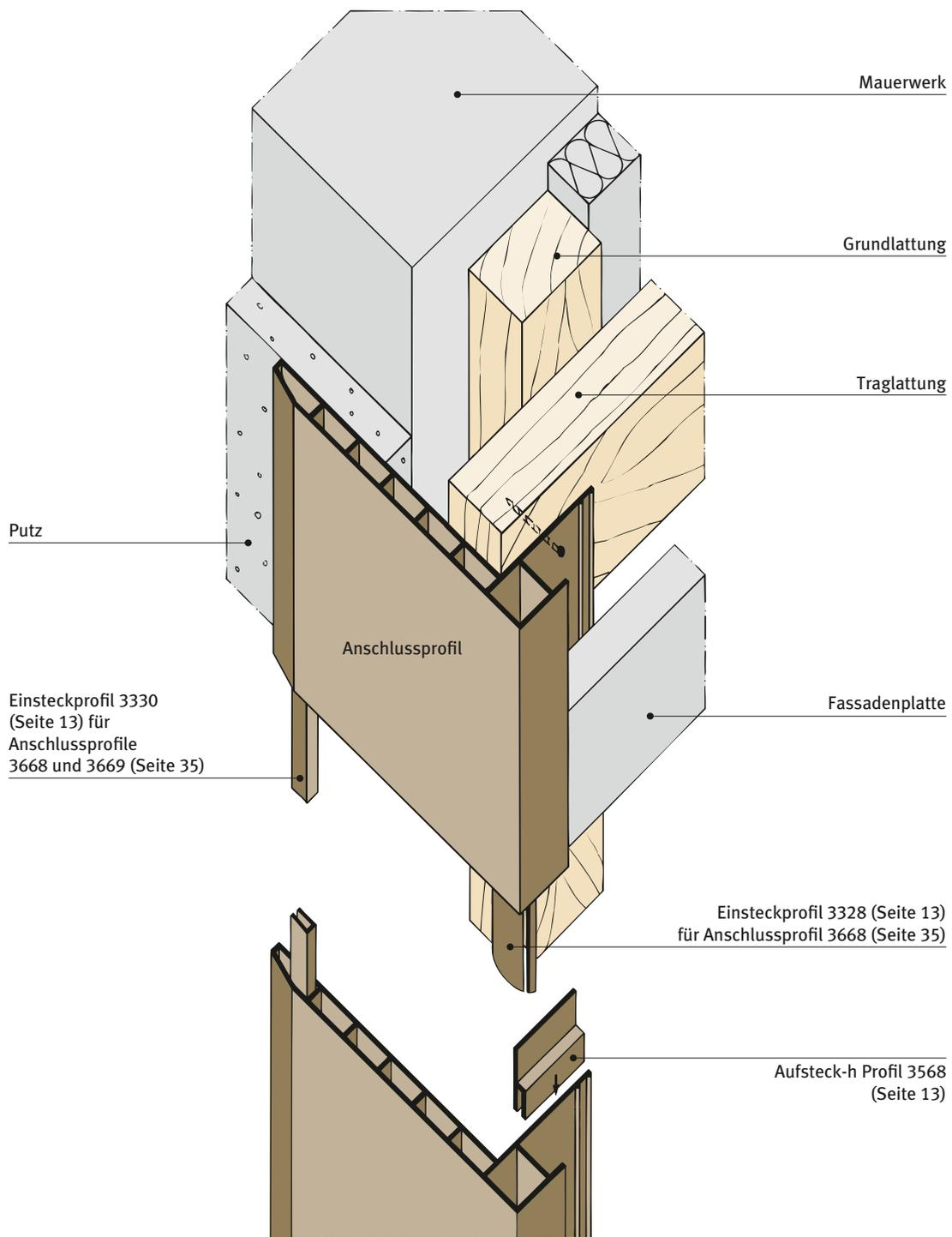
Das **Aufsteck-h Profil 3568** dichtet die Profilstöße gegen eindringendes Wasser ab.
