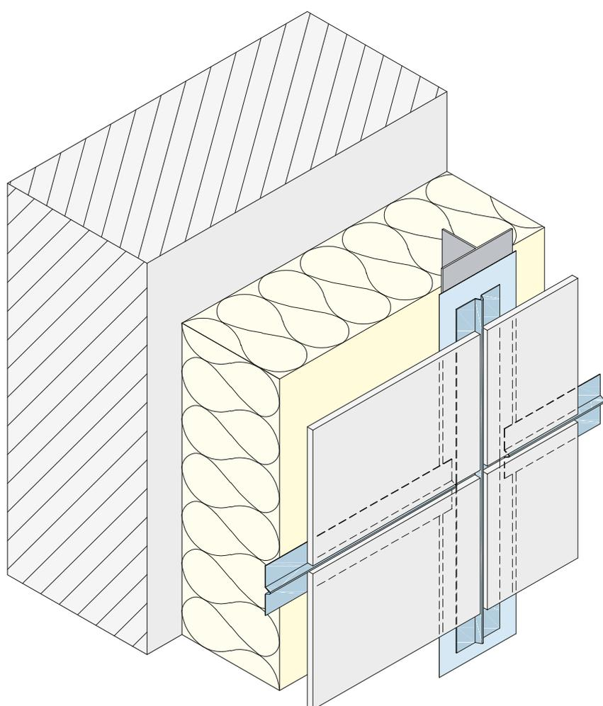
Das Fugen- bzw. Sickenprofil aus Aluminium schließt und hinterlegt dezent die Fuge. Die Sicke am Profil bewirkt auch eine Zentrierung und Führung in der Fuge der Fassadenbekleidung. Die Profile gibt es daher in 6 mm und 9 mm Breite für verschiedene Fugenbreiten. Das Sickenprofil kann horizontal und vertikal eingesetzt werden.
