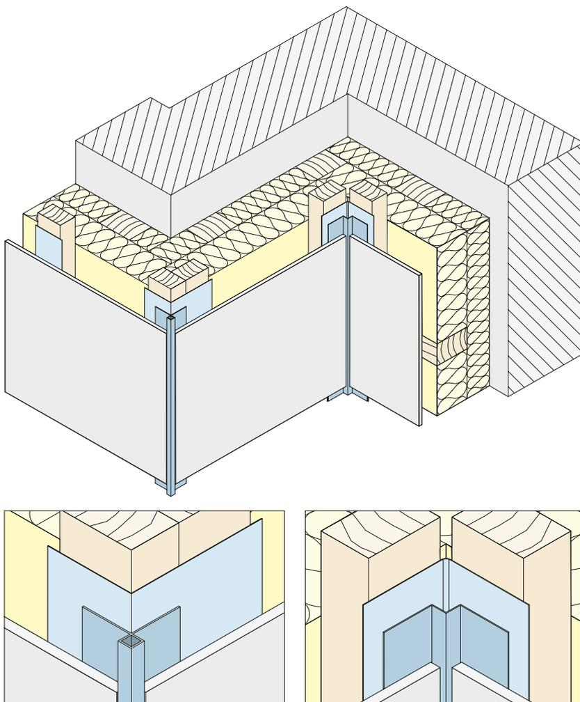
Kantenprofile dienen der Fassadengestaltung. Sie bedecken die Schnittkanten der Fassadentafeln und bilden eine saubere Kante.
