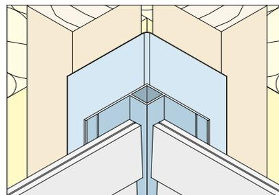
Kantenprofile dienen der Fassadengestaltung. Sie überdecken und schützen die Schnittkanten der Fassadentafeln vollständig und bilden dadurch eine saubere Kante.
