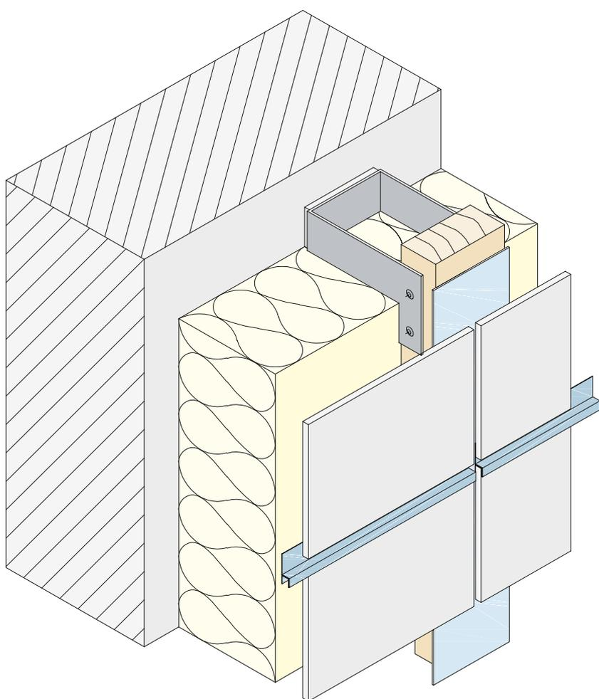
Die Fugenprofile bzw. h-Profile aus Aluminium und PVC finden Ihre Anwendung bei der horizontalen Fuge. Sie reduzieren das Eindringen von Feuchtigkeit. Bitte achten Sie darauf, dass die Platten nicht auf das Profil direkt aufgesetzt werden, sondern eine Fuge von ca. 5 bis 10 mm bzw. nach Angabe des Plattenherstellers gelassen wird.
