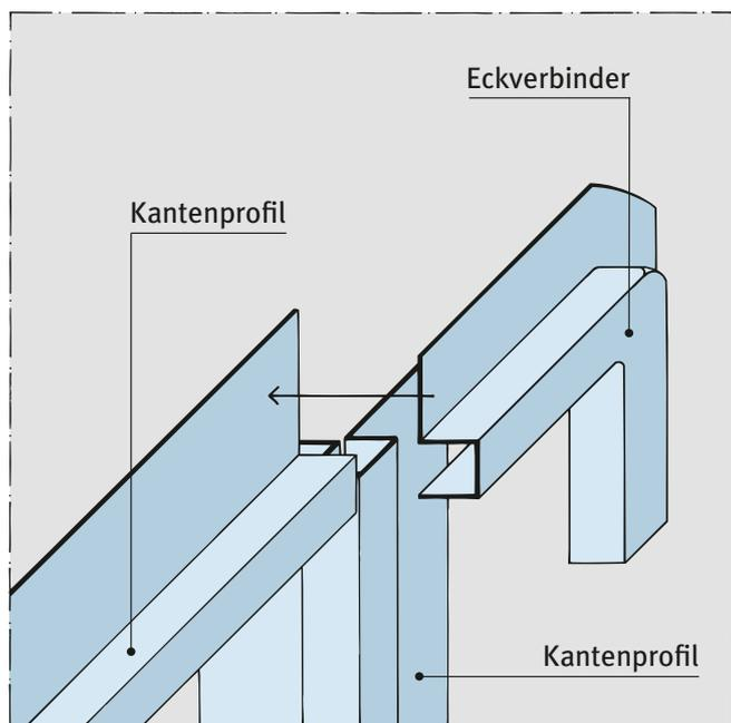
Die Eckverbinder aus Aluminium und PVC, in Verbindung mit den entsprechenden Kantenprofilen, machen das Gehrungssägen beim Übergang von den horizontalen zu den vertikalen Profilen überflüssig.
