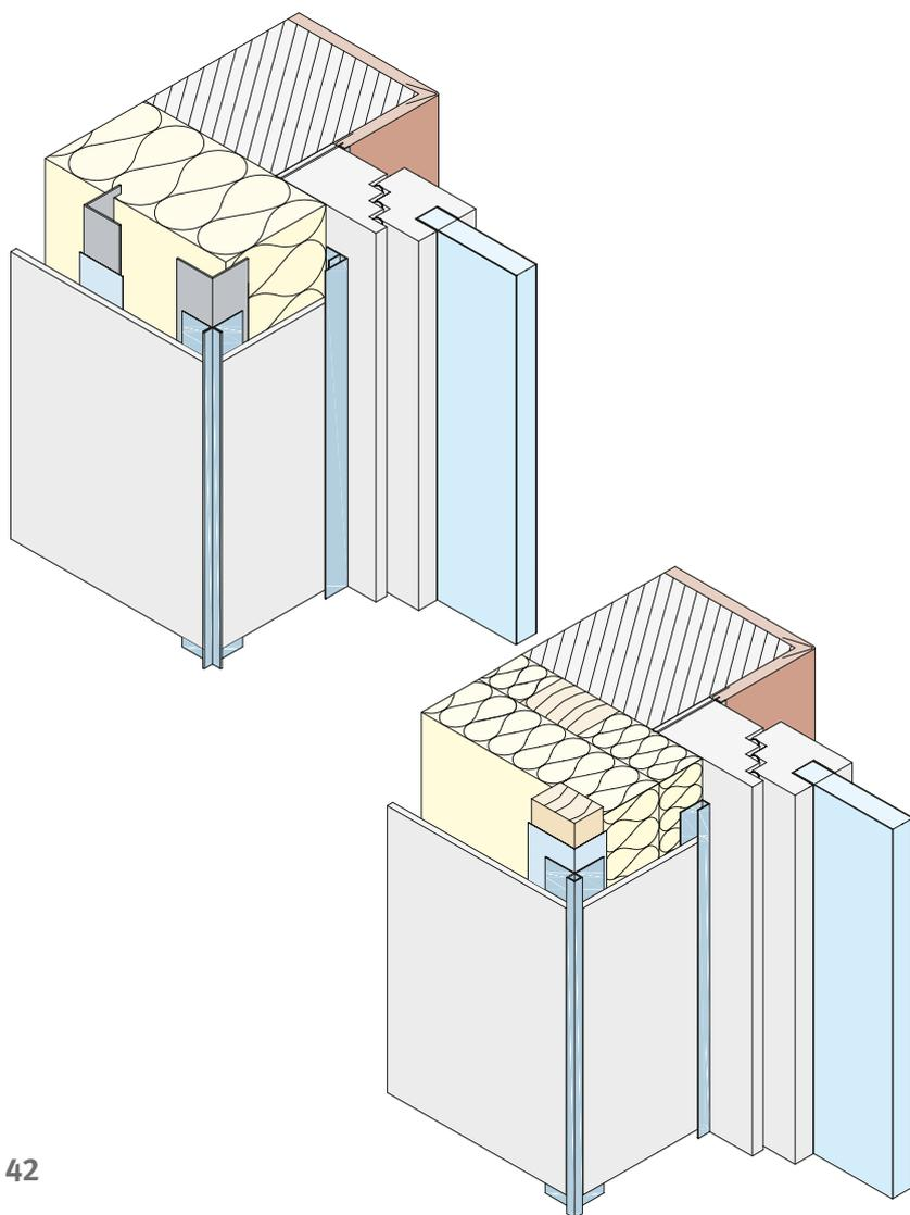
Die Laibungsausbildung kann auf unterschiedliche Arten ausgeführt werden. In der Praxis wird je nach Wunsch des Bauherrn u. a. die Fassadenbekleidung in der Laibung fortgesetzt oder auf bestehende Systeme zurückgegriffen.
